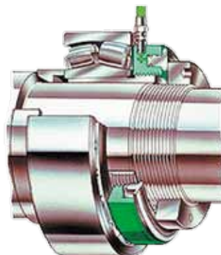
4. Matice HMV E a speciální zarážka pro montáž stahovacího pouzdra.
